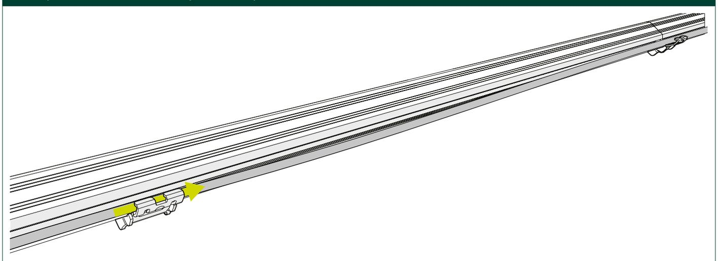
7 Coloque o módulo nas calhas e deslize o painel até aos grampos.
