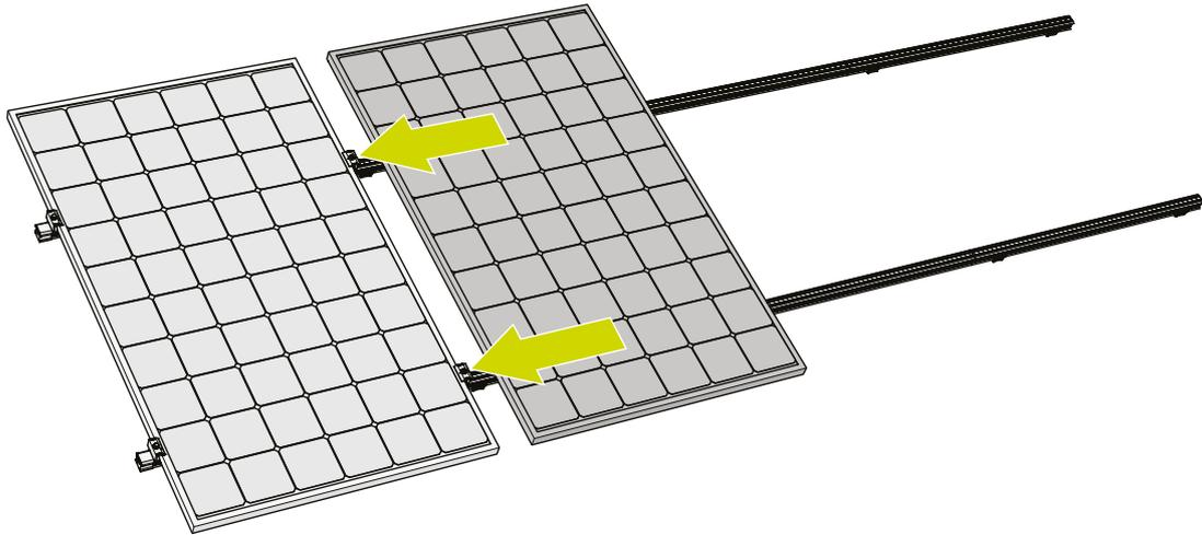
10 Fije el tornillo de las clemas/grapas finales para asegurar el panel. Aplique un par de 16,5 Nm.
