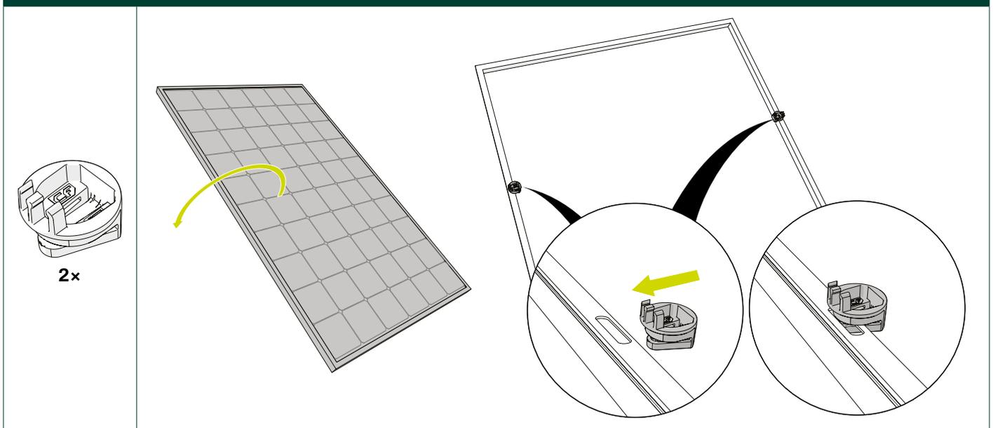
2 Opcional: Acople los cables del panel firmemente en el interior de la grapa de cable.
