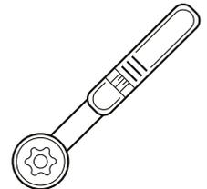
Llave dinamométrica de hasta 20 nm con punta de seguridad TR30
