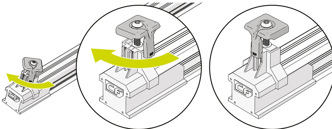
6 Opcional: Guíe los cables del panel solar a través de las conexiones de clic.
