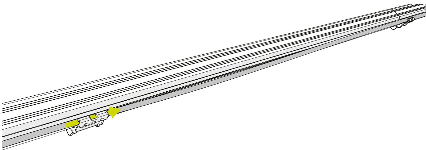
7 Coloque o módulo nas calhas e deslize o painel até aos grampos.
